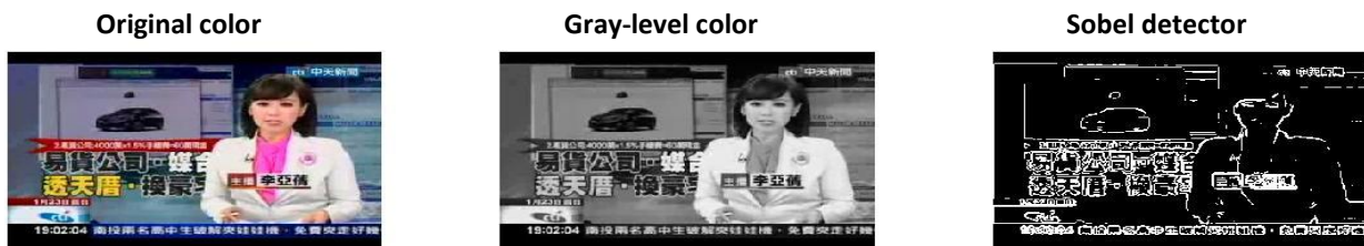
Figure III.3 : illustration de détecteur de Sobel.
